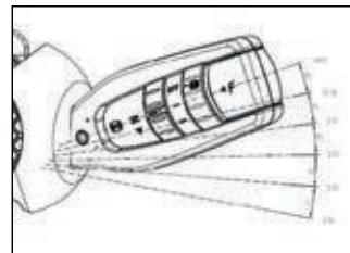
◆ **C - Поворотный переключатель режима понижающей передачи**
