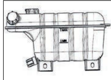
В системе охлаждения используется закрытая принудительная система водяного охлаждения, в качестве охлаждающей жидкости используется четырехсезонный антифриз длительного действия. Не следует использовать воду вместо охлаждающей жидкости.
