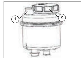
При заправке запустите двигатель и поддерживайте его стабильную работу на низких оборотах. По мере добавления нового масла в бак поворачивайте рулевое колесо влево и вправо до упора и повторяйте до тех пор, пока не станет очевидно, что в маслоотводе нет воздуха. Выключите двигатель, установите масляную поверхность бака в указанное выше положение, закрутите крышку.
